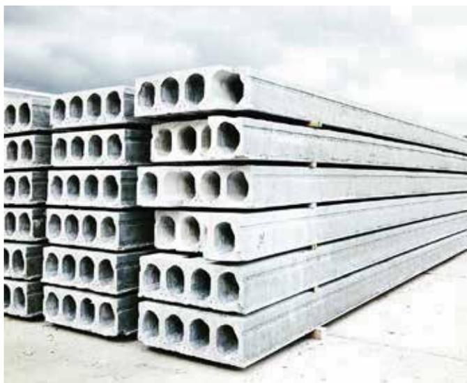
Le lastre Kypse sono prodotte per estrusione con calcestruzzo vibrato del tipo C45/55 con classe di durabilità XC3, nel rispetto delle nuove Norme Tecniche. Viene utilizzata una miscela di acqua e cemento che assicura un'elevata resistenza alla compressione e alla trazione permettendo l'uso dei solai Kypse anche in presenza di grandi luci ed elevati sovraccarichi.
